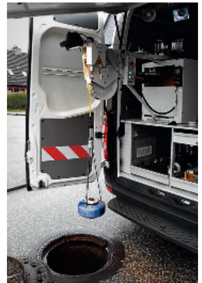
Die Untersuchung der Schächte wird vom Kanalinspektionsfahrzeug aus vorbereitet.
