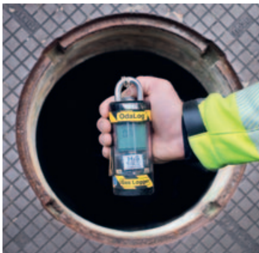
Messgerät zur Erfassung von Schwefelwasserstoffaustritt.
