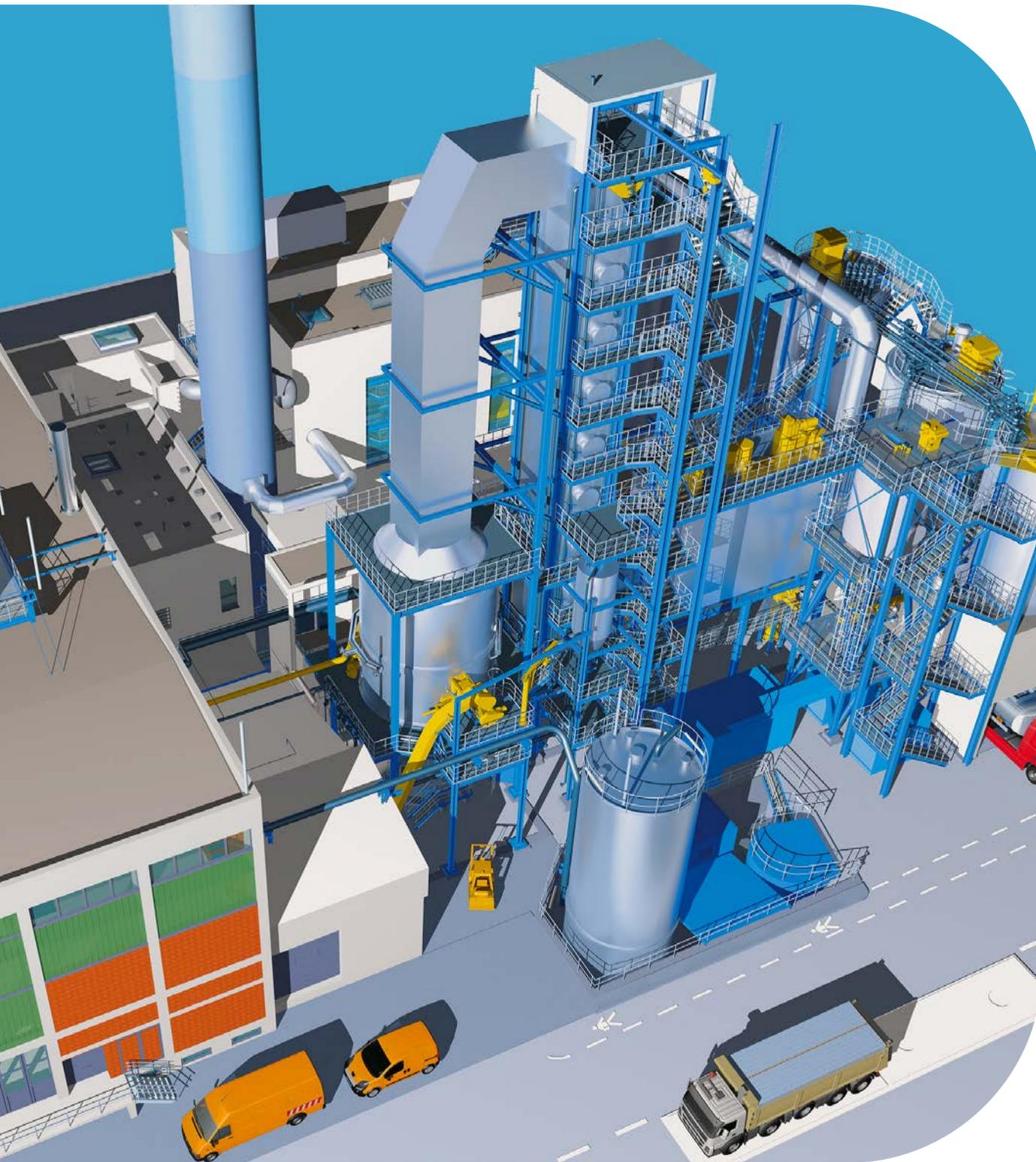
Es ist aktuell das größte Projekt der SES in Planung: Um die Verbrennung des Klärschlammes und somit die thermische Verwertung im Hauptklärwerk Mühlhausen auch künftig zu garantieren, wird einer von zwei Wirbelschichtöfen schrittweise erneuert. Die bei der Abwasserreinigung anfallenden Klärschlämme aller vier Stuttgarter Kläranlagen und zahlreicher Klärwerke der Nachbarkreise werden derzeit im Hauptklärwerk verbrannt.
